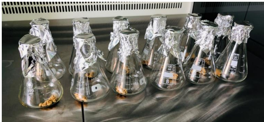
Slika 3. Biosorbens u Erlenmeyerovim tikvicama, pripremljen za provođenje šaržnih adsorpcijskih eksperimenata.
