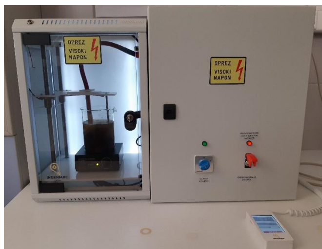
Slika 3 Uređaj za visokonaponsko električno pražnjenje
