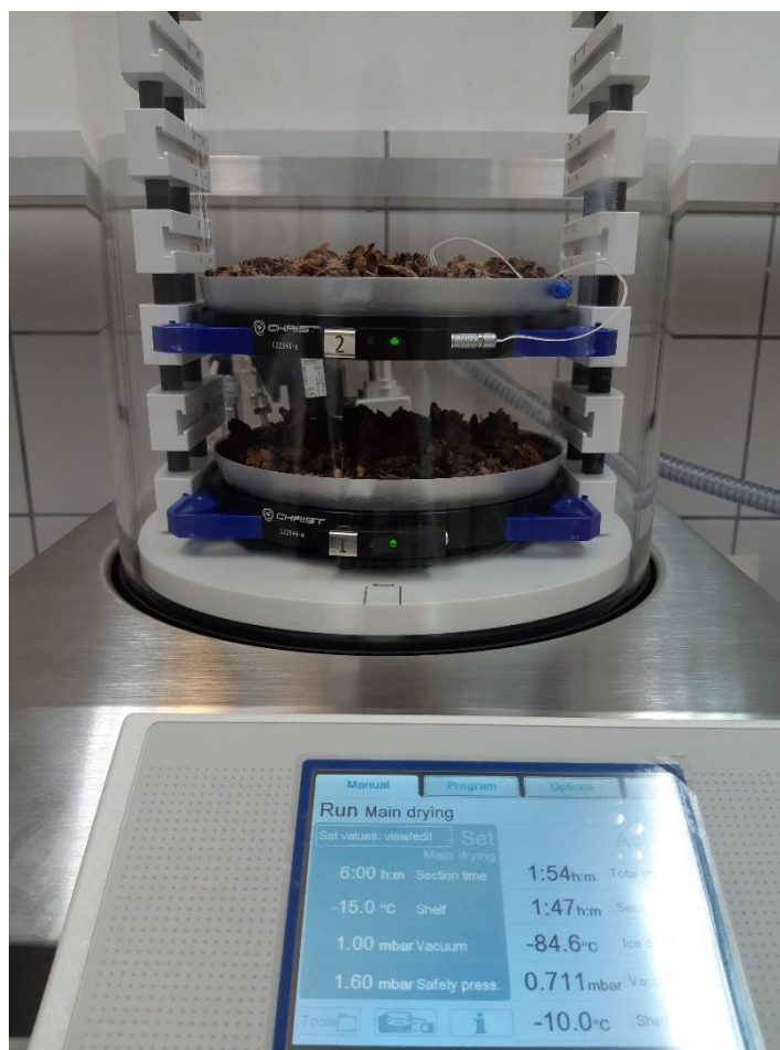
Slika 9 Liofilizacija kakaove ljuske
