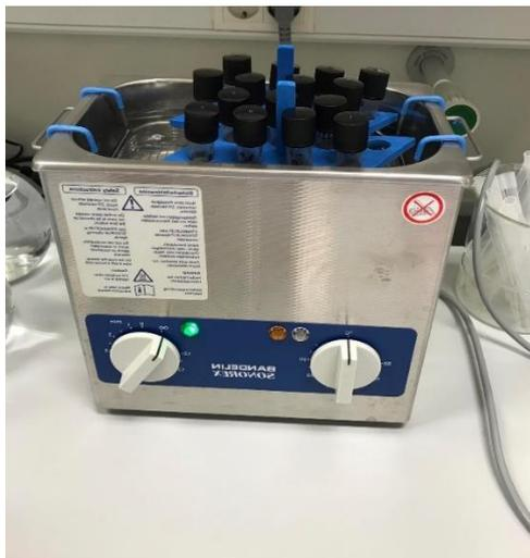
**Slika 18** Ultrazvučna kupelj
