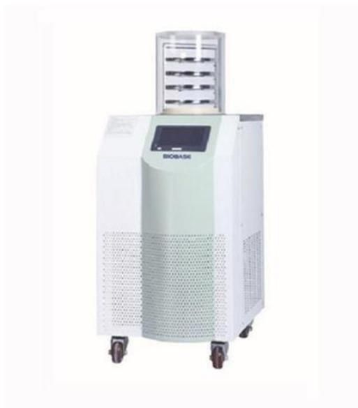
**Slika 9** Laboratorijski liofilizator (Web izvor 7)
