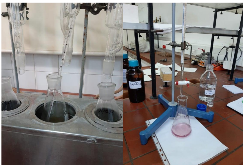
Slika 13 Postupci određivanja ukupnih kiselina (Izvor: autor)
