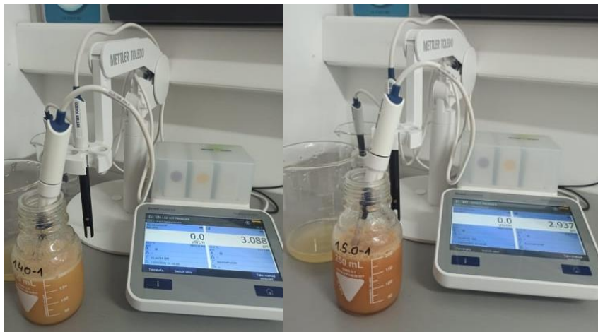
Slika 11 Određivanje pH vrijednosti (Izvor: autor)
