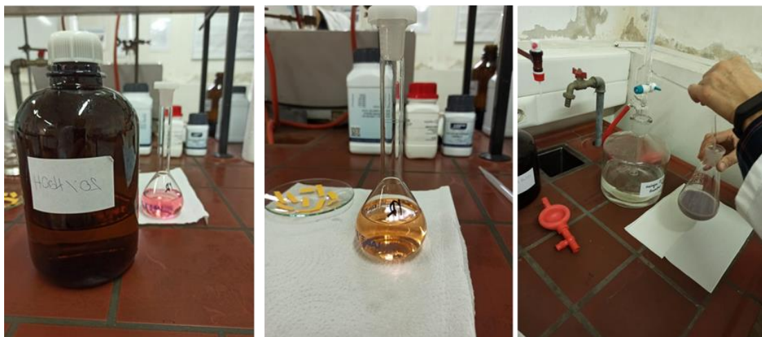
neutralizacija s 20% -tnom NaOH
