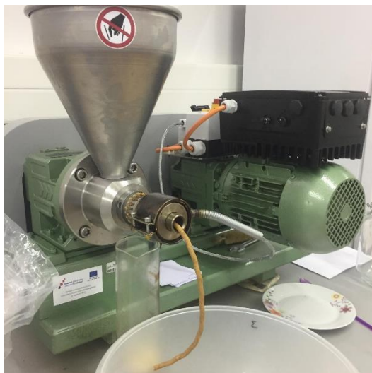
Slika 4 Laboratorijska kontinuirana pužna preša (Izvor: autor)
