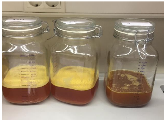
Slika 2 Proces taloženja (sedimentacija) (Izvor: autor)
