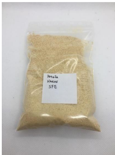
Slika 8 Mljevena pogača nakon superkritične CO 2 ekstrakcije (Izvor: autor)
