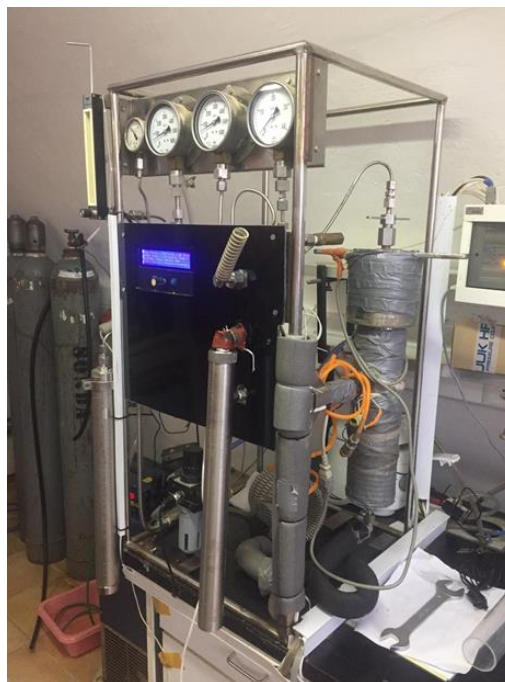
Slika 5 Uređaj za superkritičnu CO 2 ekstrakciju (Izvor: autor)
