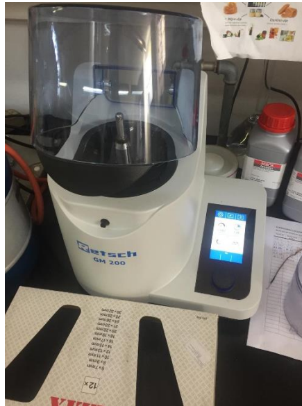
Slika 6 Mlin (Retsch GM 200) (Izvor: autor)
