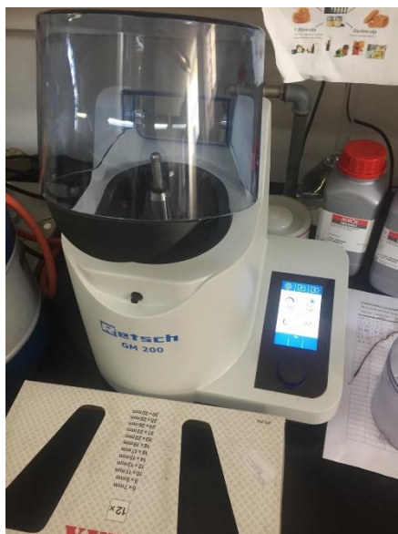
Slika 6 Mlin (Retsch GM 200) (Izvor: autor)
