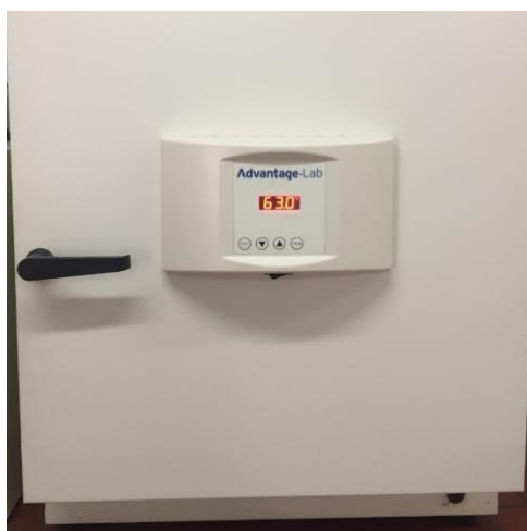
Slika 19 Sušionik zagrijan na 63 °C
