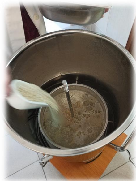
Slika 10 Ubacivanje samljevenog slada u zagrijanu vodu (izvor: privatna arhiva)
