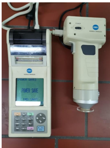
Slika 11 Uređaj za mjerenje boje Konica Minolta Chroma Meter CR-400 korišten za izradu diplomskog rada
