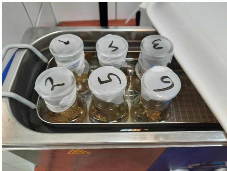
Slika 7 Ekstrakcija uzoraka potpomognuta ultrazvukom (izvor: Autor)
