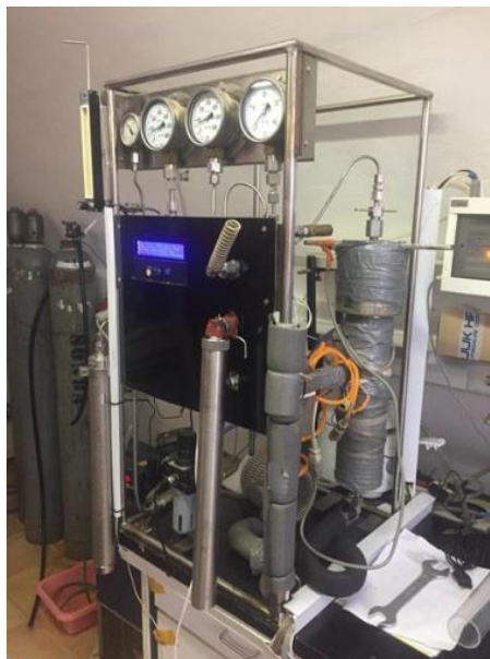
Slika 5 Uređaj za SC-CO 2 (izvor: Autor)
