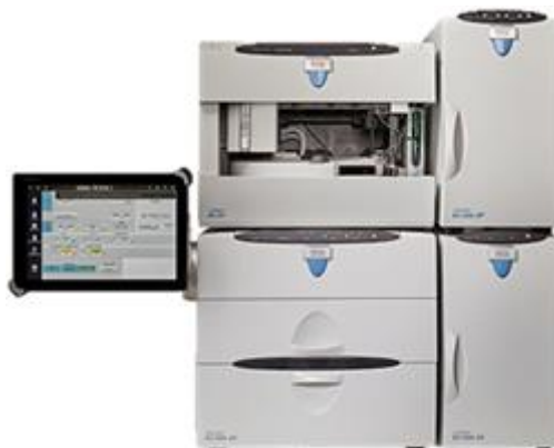
Slika 8. Ionski kromatograf za određivanje koncentracije amonijaka
