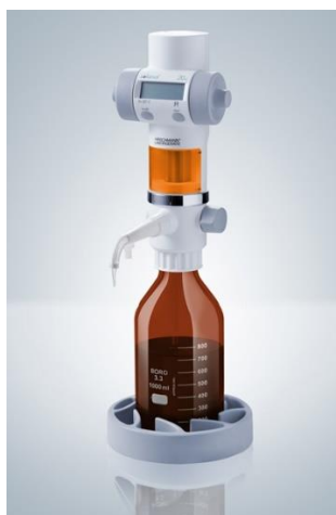
Slika 7. Automatska bureta za titiranje kalijeva permanganata
