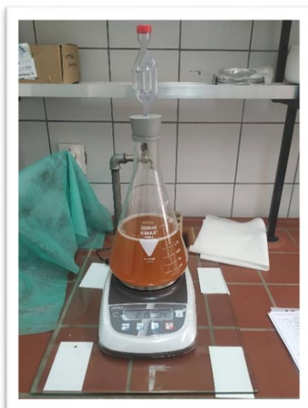
Slika 9 Mjerenje mase uzoraka tijekom provedbe mikrofermentacije
