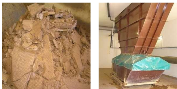
Slika 15. Filterski kolač i spremnik filterskog kolača
