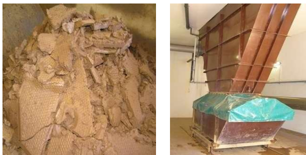
Slika 15. Filterski kolač i spremnik filterskog kolača
