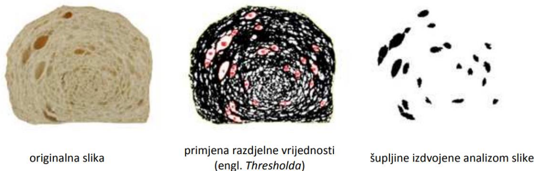
Slika 8. Postupak izdvajanja šupljina računalnom analizom slike
