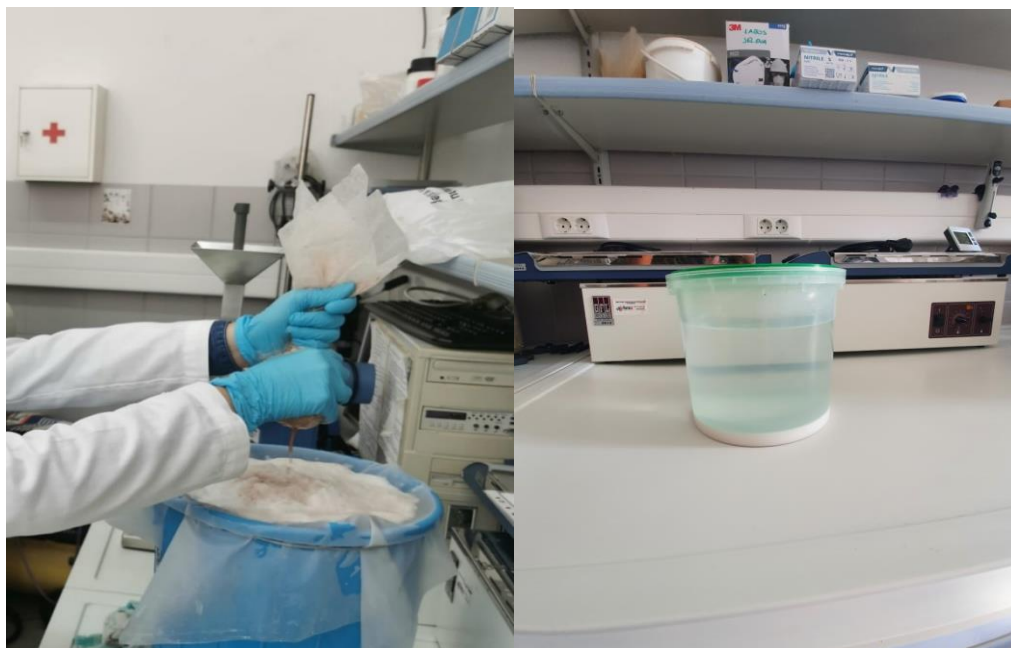
Slika 11 Postupak ručnog ispiranja škroba (a) i taloženje škroba (b)
