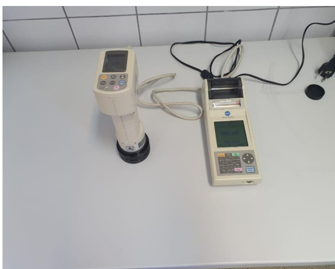
Slika 13 Kromametar Konica Minolta CR – 300
