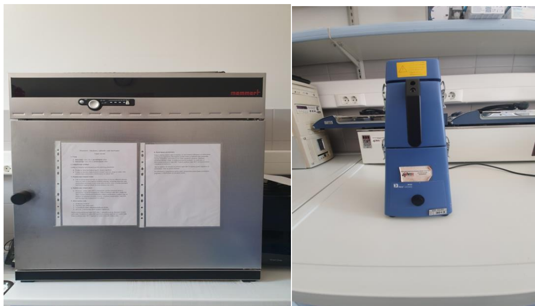
Slika 12 Laboratorijski sušionik Memmert UFE 500 (a) i mlin IKA M20 (b)
