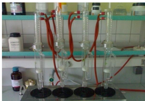
Slika 14 Aparatura za ekstrakciju masti po Soxhletu (Jozinović, 2015)
