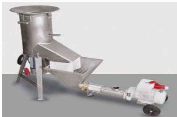
Slika 1 Gnječilica i sjeckalica
