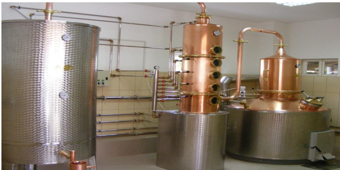
Slika 5 Kotao za destilaciju s kolonom i deflegmatorom
