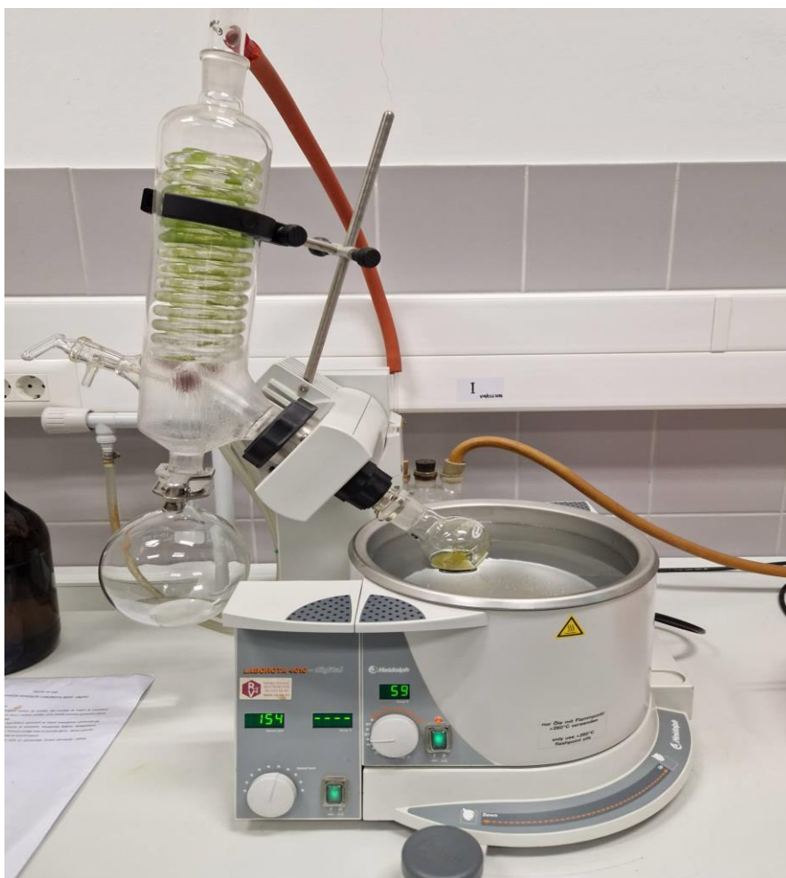
Slika 6. Rotacijski vakuum uparivač (Laborota 4010, Heidolph Instruments GmbH & Co. KG, Schwabach, Njemačka) (Izvor: autor)
