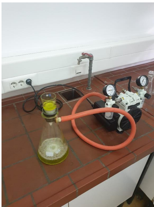
Slika 9 Filtracija organskim otapalom
