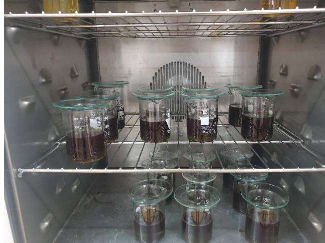
Slika 11 Uzorci u sušioniku za određivanje oksidacijske stabilnosti
