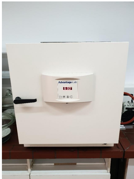
Slika 12 Laboratorijski sušionik zagrijan na 63 °C
