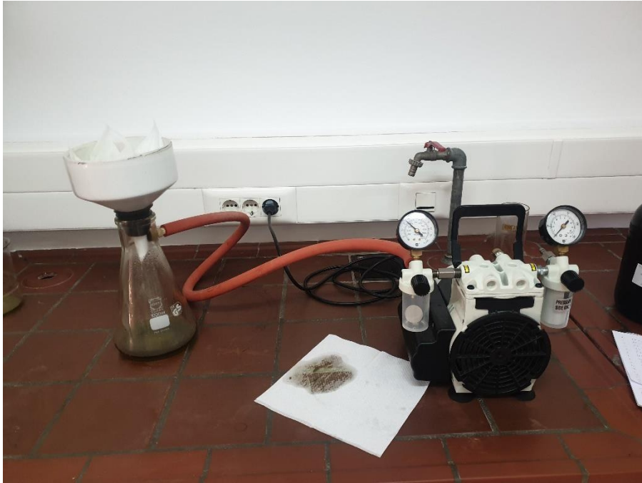
Slika 6 Vakuum filtracija sirovog ulja
