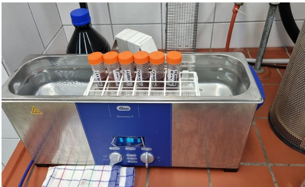
Slika 7. Ekstrakcija resveratrola potpomognuta ultrazvukom (Izvor, autor)
