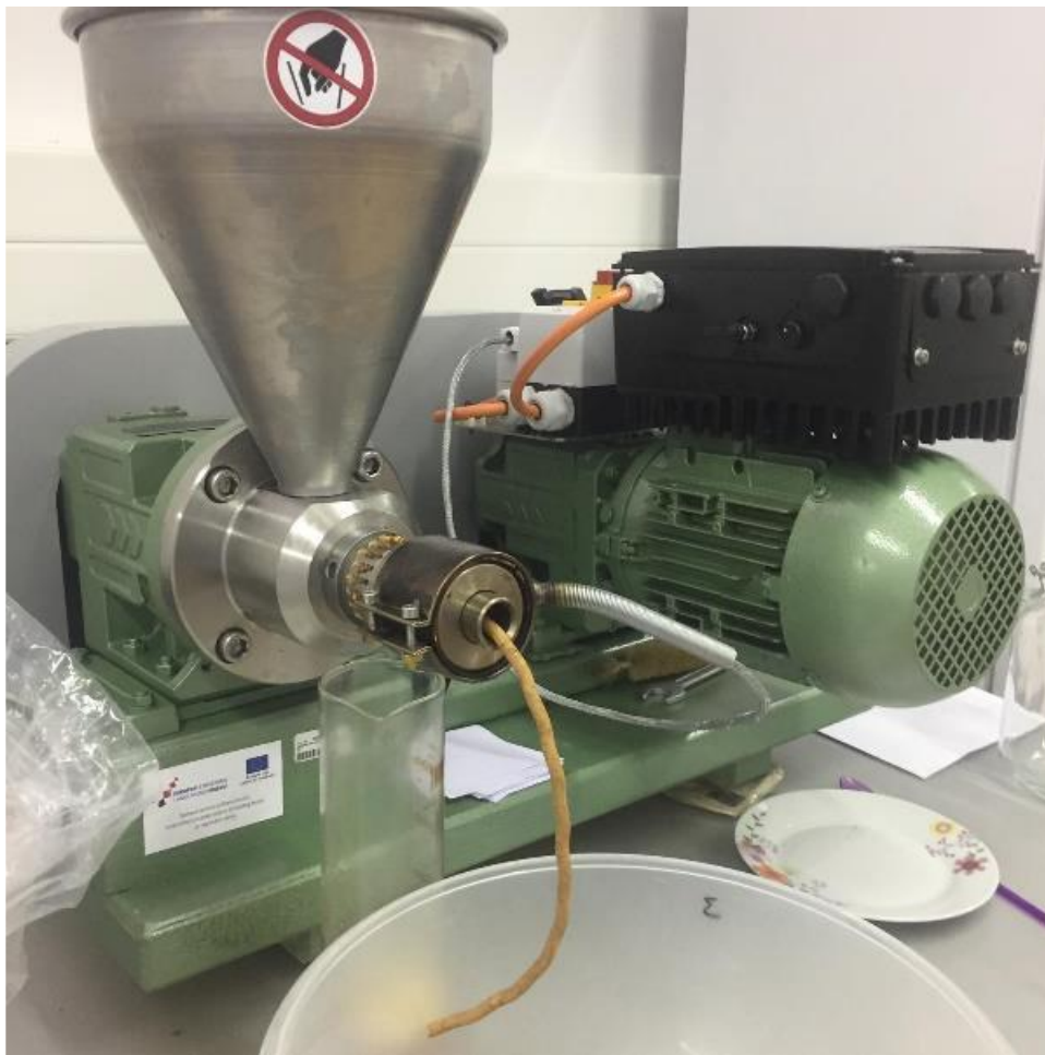
Slika 2. Laboratorijska kontinuirana pužna preša (Kušević, 2022)
