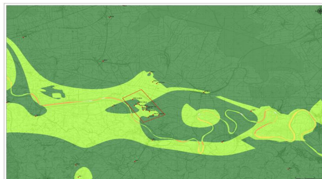
Slika 6. Karta specifične ranjivosti vodonosnika za vrijeme visokih voda-lindane Figure 6. Map of specific aquifer vulnerability during high water-lindane
