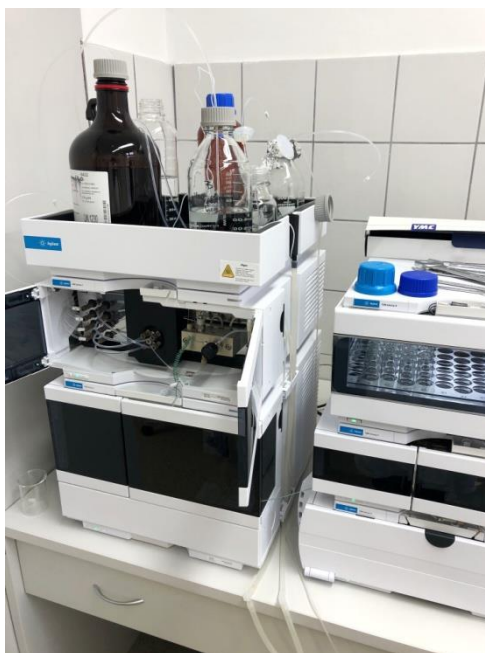
Slika 9 HPLC sustav korišten za identifikaciju i kvantifikaciju pigmentata u ekstraktima makroalgi (Izvor: autor)
