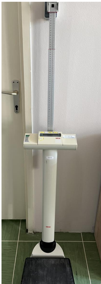
Slika 7 Vaga s visinomjerom Seca 704S klasa III na kojoj su provedena mjerenja mase i visine u okviru istraživanja
