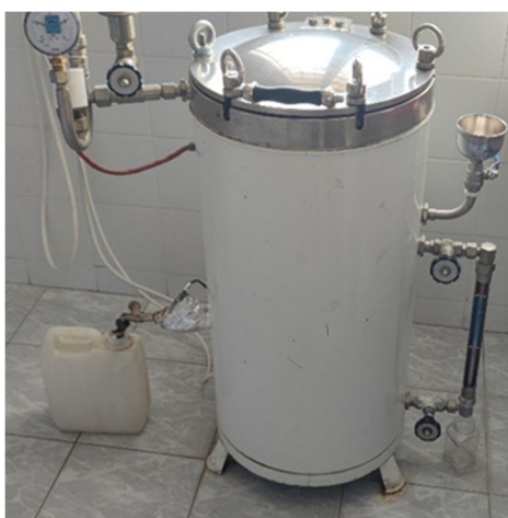
Slika 6 Autoklav (TIP 7510945, Sutjeska, Beograd)
