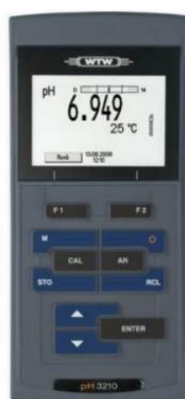
Slika 16. Prijenosni pH metar pH 3210 (Katalog opreme Prehrambeno-tehnološkog fakulteta Osijek, 2022.)
