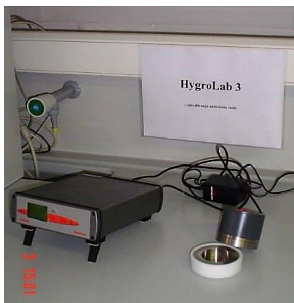
Slika 14. Rotronic - HygroLab 3 – Multi-channel Humidity Water Activity Analyser (Katalog opreme Prehrambeno-tehnološkog fakulteta Osijek, 2022.)
