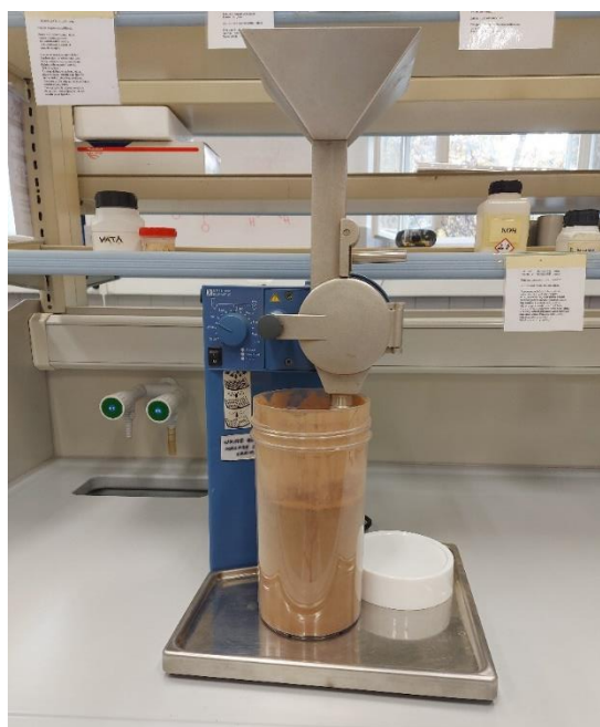
Slika 2 Mljevenje ljuske crvenog luka na granulaciju od 0,5 mm
