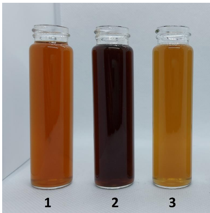
Slika 5 Ekstrakti dobiveni nakon subkritične ekstrakcije : 1 - 96 % etanol, 2 - 50 % etanol, 3 - voda
