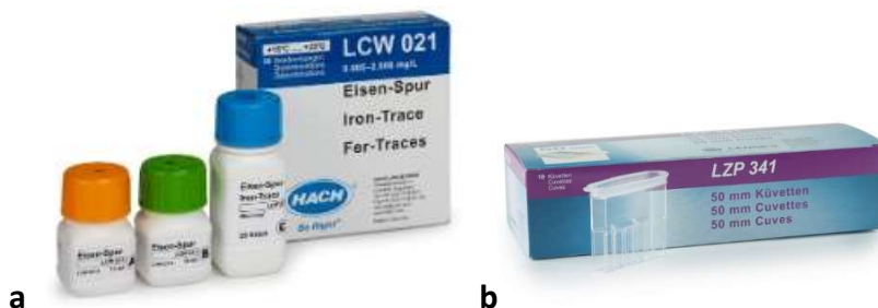
Slika 7. Set reagensa LCW 021 (a) i pravokutne kivete od 50 mm (b) korištene za određivanje koncentracije ukupnog željeza spektrofotometrom DR 6000 (Hach, Njemačka)
