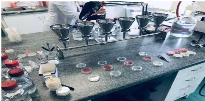
Slika 9. Uređaj za membransku filtraciju Zavoda za javno zdravstvo Požeško-slavonske županije
