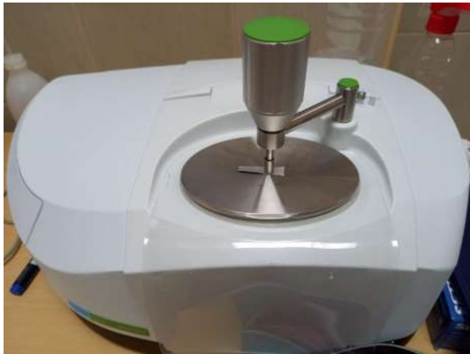
Slika 7. FTIR spektrometar Spectrum One Perkin-Elmer (Izvor: autor).
