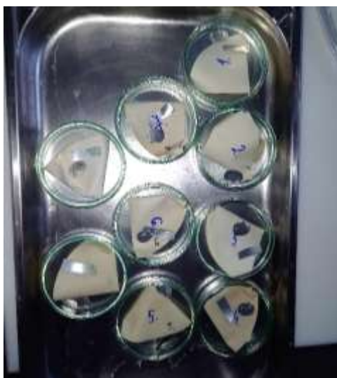
Slika 6. Pripremljeni uzorci za analizu sa ocijeđenim filter papirom, tijelom i poklopcem limenke (Izvor: autor).
