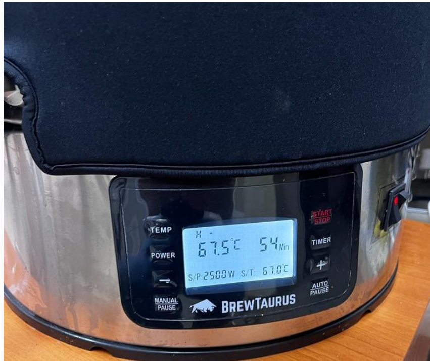
Slika 15 Početak ukomljavanja tj. ekstrakcije slada pri temperaturi vode od 67,5 °C u trajanju ekstrakcije od 60 minuta (Izvor privatna arhiva)
