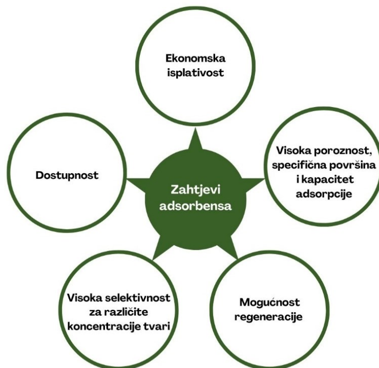
Slika 5. Zahtjevi koji se postavljaju za primjenu nekog materijala kao adsorbensa/biosorbensa (prema Rapo i Tonk, 2021.).
