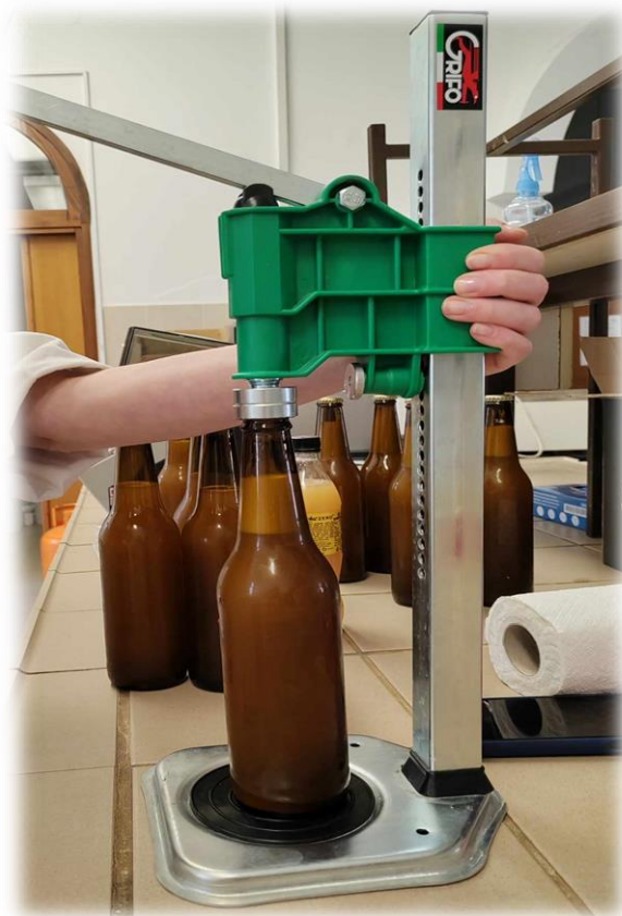
Slika 18: Uređaj Grifo za zatvaranje staklenih boca metalnim čepom (izvor: privatna arhiva)
