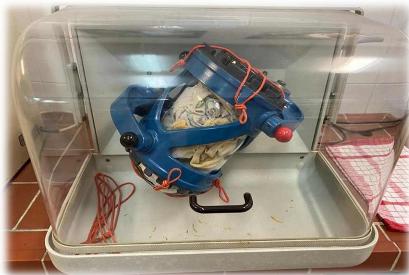
Slika 21: Mućkanje i centrifugiranje uzorka (izvor: privatna arhiva)
