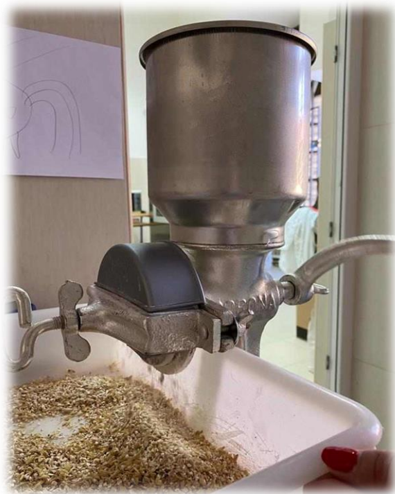
Slika 3: Laboratorijski mlin za usitnjavanje ječma (izvor: privatna arhiva)
