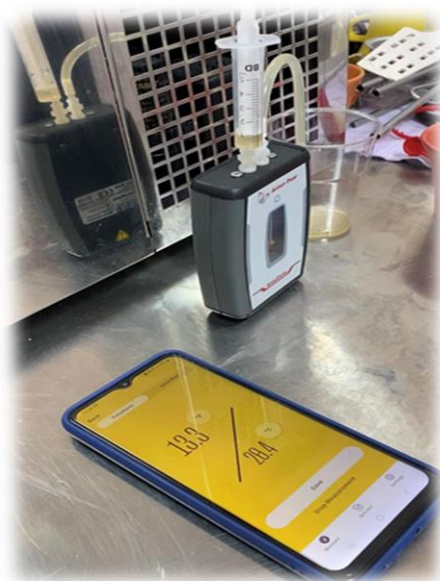
Slika 14: EasyDens uređaj za određivanje količine fermentabilnih šećera (izvor: privatna arhiva)
