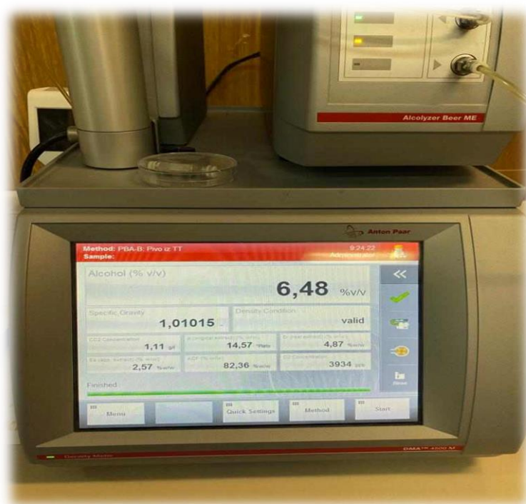
Slika 26: Prikaz rezultata izmjerenih parametara na uređaju Beer Analyzer (izvor: privatna arhiva)
