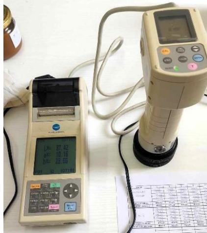
Slika 14. Određivanje boje kromametrom
