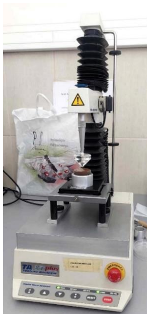
Slika 16. Prikaz analizatora teksture TA.XT Plus, Stable Micro systems
