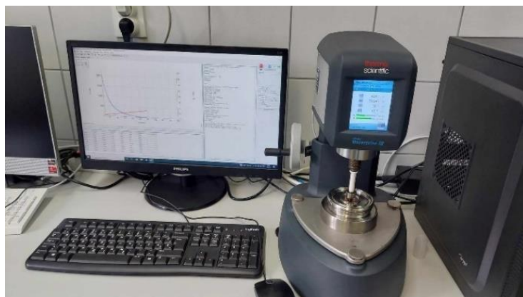
Slika 17. Prikaz reometra HAAKE Viscotester iQ
