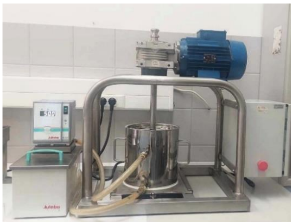
Slika 11. Prikaz kugličnog mlina
