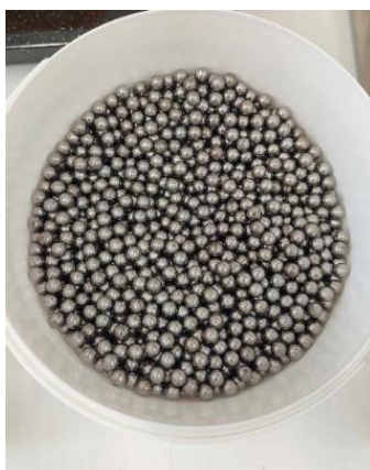
Slika 12. Prikaz kuglica za kuglični mlin
