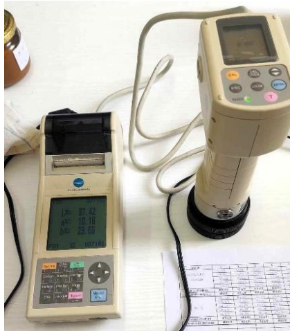
Slika 14. Određivanje boje kromametrom
