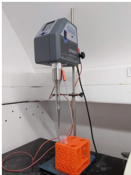
Slika 11 Ultrazvučna sonda UP400St (Izvor: autor)
