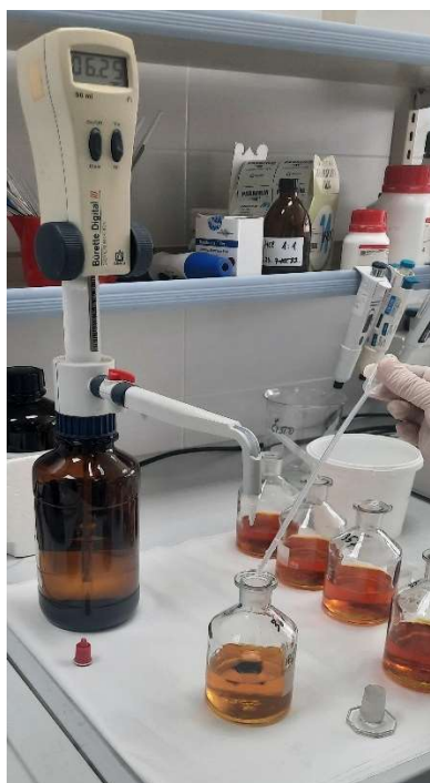
Slika 24 Dodatak indikatora i titracija
