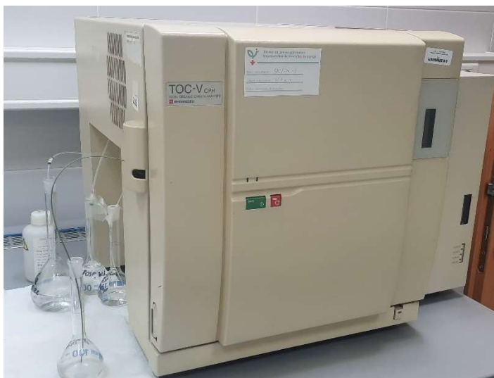
Slika 13 TOC-V CPH/CPN+TNN-1 uređaj za određivanje ukupnog organskog ugljika i dušika
