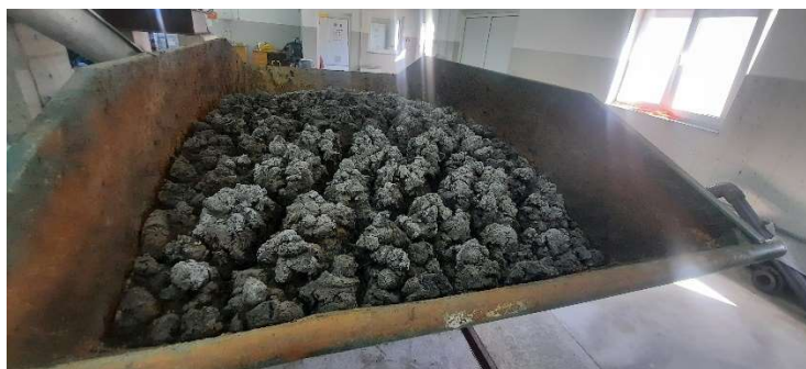
Slika 11 Isušeni mulj na UPOV Đurđevac
