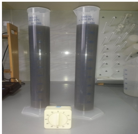
Slika 3 Postavljena aparatura za mjerenje brzine taloženja
