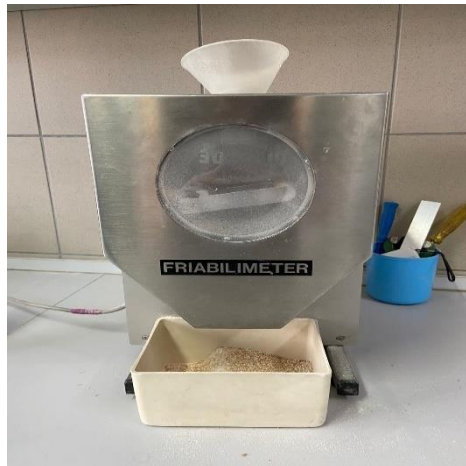
Slika 10. Friabilimetar-uređaj za mjerenje krhkosti ili lomljivosti
