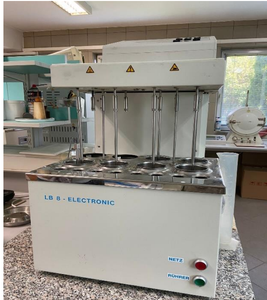
Slika 12. Uređaj za Hartong pri 45 °C
