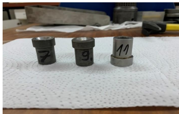
Slika 20 Nastavci koji reguliraju debljinu pogače
