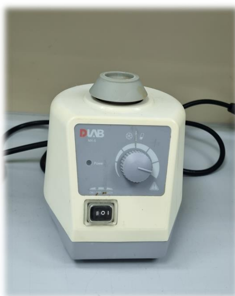
Slika 9 Vorteks (Vortex MX-S, DLAB Scientific, Kina)
