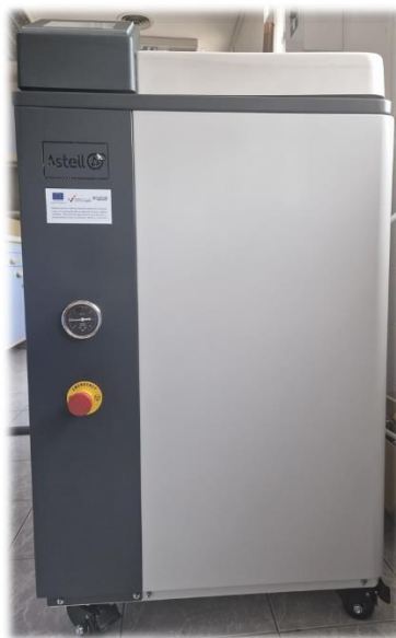
Slika 6 Autoklav (ASTELL AMA270, Kent, Ujedinjeno Kraljevstvo)
