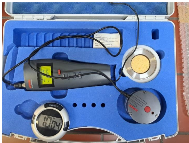
Slika 9 Uređaj za mjerenje aktiviteta vode
