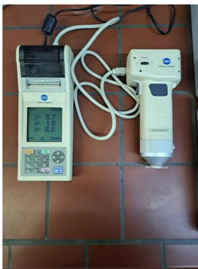
Slika 8 Kolorimetar Konica Minolta CR-400
