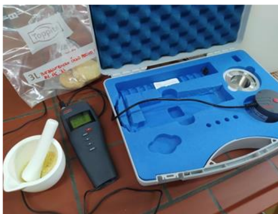
Slika 4 Uređaj za određivanje aktiviteta vode
