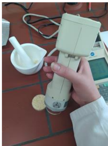
Slika 6 Uređaj za određivanje boje
