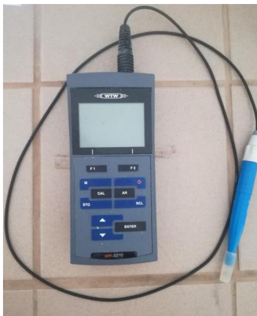
Slika 6 pHmetar WTW pH 3210 (WTW) s ubodnom elektrodom BlueLine 21 (SCHOOT)
