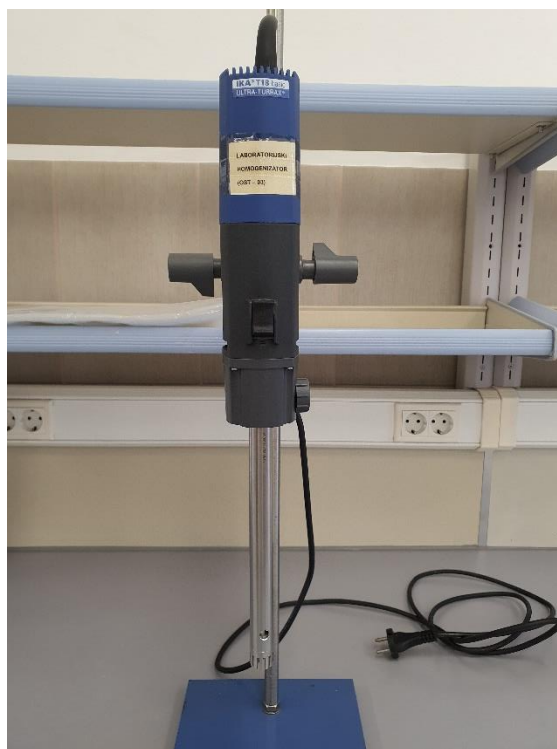
Slika 5 Laboratorijski homogenizator Ultra-Turrax T 18 (IKA)
