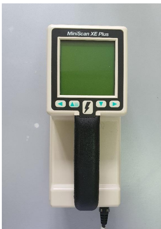
Slika 9 Hunter-Lab Mini ScanXE (A60-1010-615 Model Colorimeter, Hunter-Lab, Reston, Va, USA)
