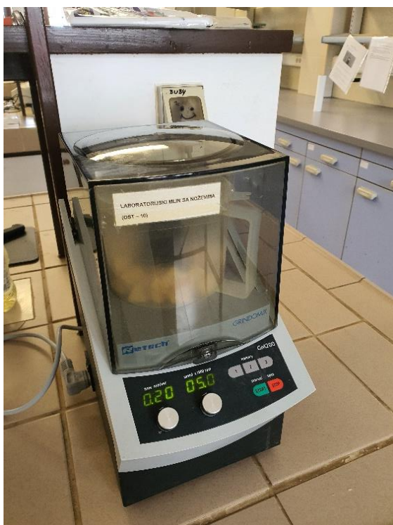
Slika 3 Laboratorijski mlin s noževima Grindomix
