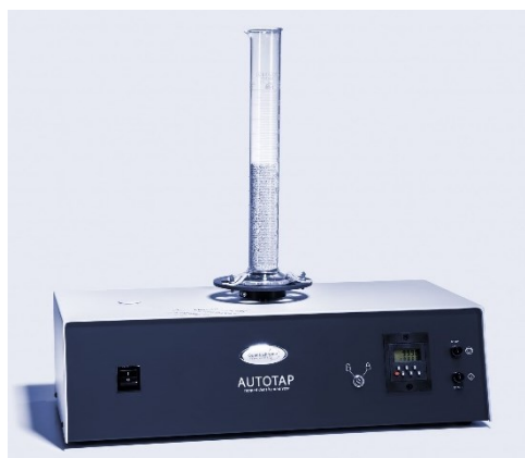
Slika 14. Uređaj za određivanje gustoće praha nakon potresanja (AutoTap, Anton Paar, Austrija)
