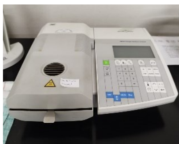
Slika 11. Halogeni analizator vlage HR73 (Mettler Toledo, USA)
