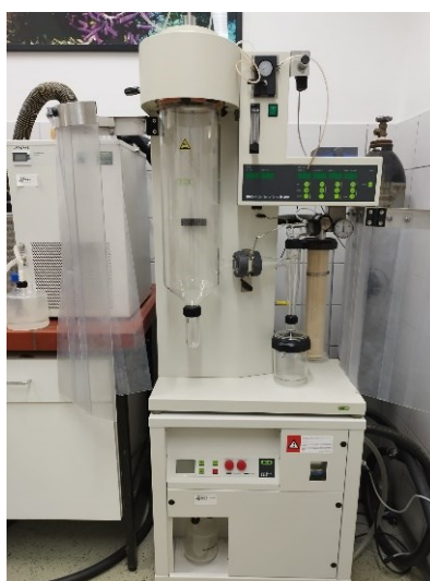
Slika 10. Mini Spray Dryer B-290, Büchi, Švicarska
