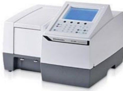
Slika 15. Spektrofotometar (Shimadzu UV-1280, Shimadzu, Japan)
