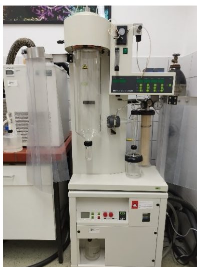
Slika 10. Mini Spray Dryer B-290, Büchi, Švicarska
