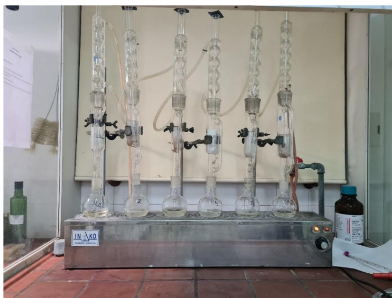
Slika 19 Ekstrakcija ulja po Soxhlet-u
