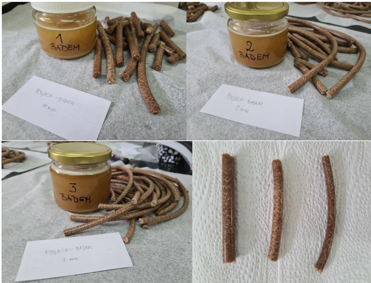
Slika 13 Dobiveno sirovo ulje i tri pogače različite debljine zbog različitih nastavaka za izlaz pogače
