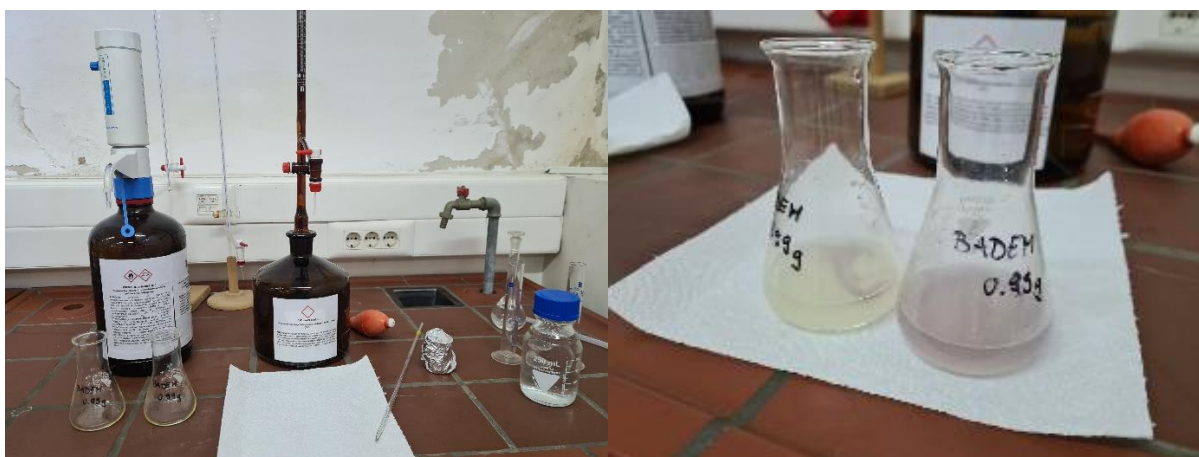
Slika 21 Određivanje peroksidnog broja u ulju (po Wheeleru)
