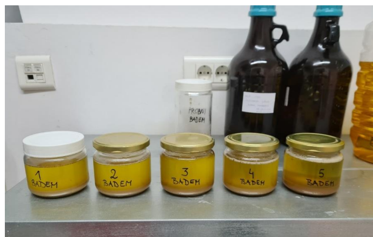
Slika 14 Izdvajanje taloga iz sirovog ulja sedimentacijom
