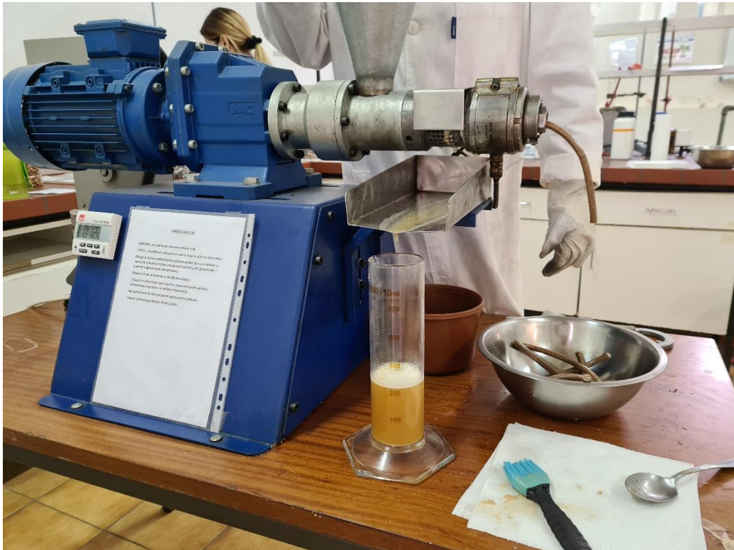
Slika 12 Laboratorijska pužna preša (proizvodnja sirovog ulja i pogače)
