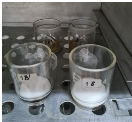
Slika 20 Određivanje vlage i netopljivih nečistoća u ulju
