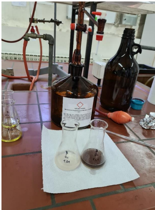
Slika 22 Oksidacijska stabilnost – određivanje peroksidnog broja u ulju
