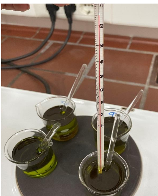
Slika 15 Zagrijavanje uzorka uz miješanje (Izvor: autor)
