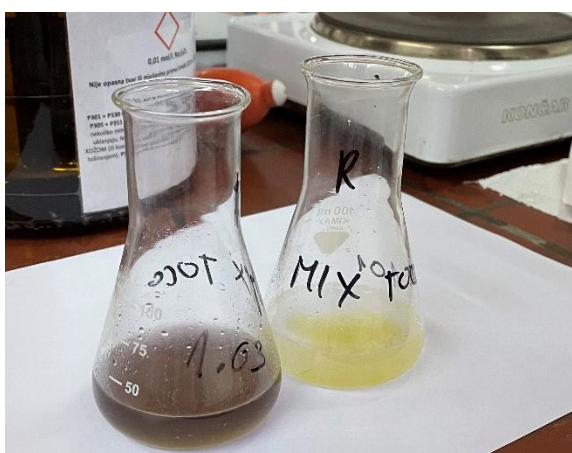
Slika 18 Promjena boje nakon titracije za određivanje peroksidnog broja (Izvor: autor)
