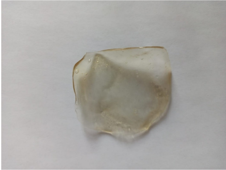
Slika 31 Biopolimerni material napravljen od materiala škrob-polifenoli kore jabuke 1
