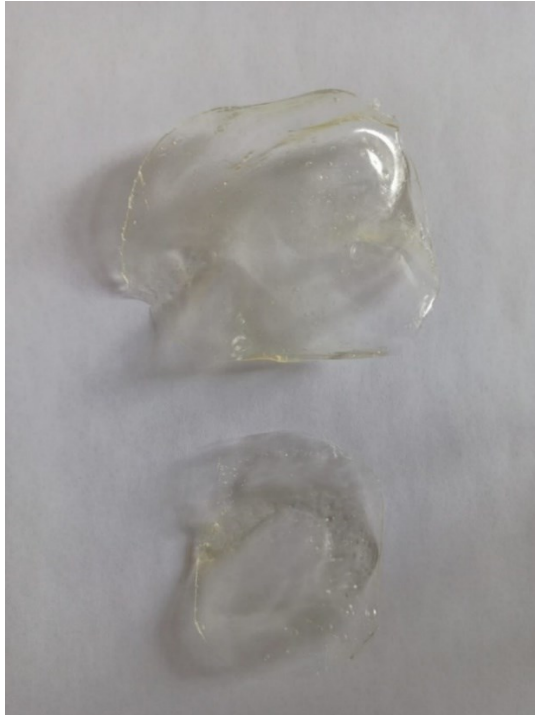
Slika 27 Biopolimerni materijal napravljen od škroba s dodanih 3 g plastifikatora (glicerol)
