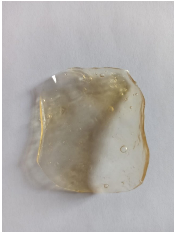
Slika 32 Biopolimerni material napravljen od materiala škrob-polifenoli kore jabuke 2
